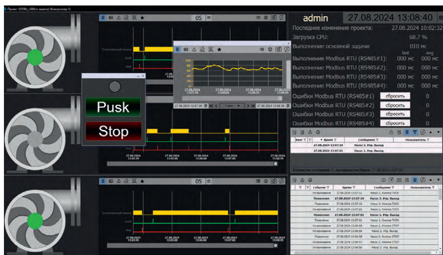
Рис. 9. Реализация проекта в MasterSCADA для ПЛК «SIMBOL-300»
