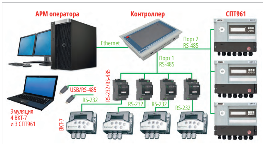
Рис. 1. Структурная схема учёта теплопотребления и ГВС
