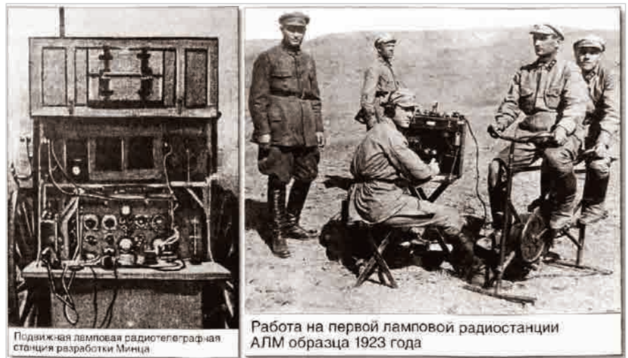
Рис. 1. Первая советская военная ламповая радиостанция АЛМ, разработанная А.Л. Минцем
