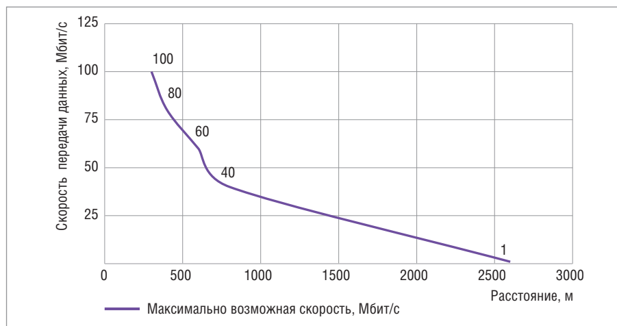
Рис. 4. Зависимость скорости передачи данных от длины линии для EtherWAN ED3501, ED3541, ED3575
