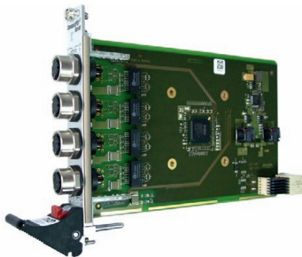
Рис. 9. Плата G211 формата 3U CompactPCI® Serial с 4 портами Gigabit Ethernet компании MEN Mikro Elektronik GmbH
