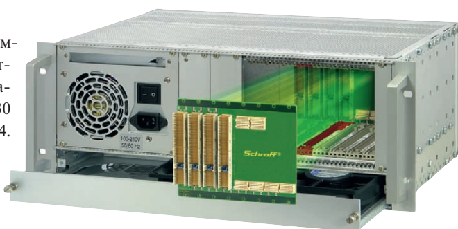
Рис. 7. Системный блок Schaffner с бекплейном PICMG 2.30 CompactPCI PlusIO
