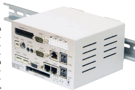
Рис. 9. Защищённый компьютер MK150 (FASTWEL) с креплением для установки на DIN-рейку
