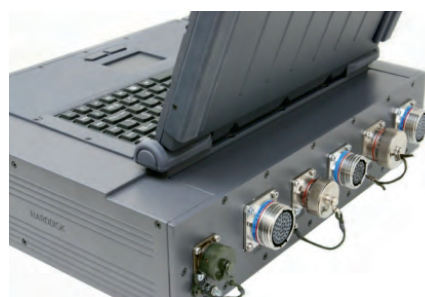
Рис. 6. Вариант доработки задней панели ноутбука A790
