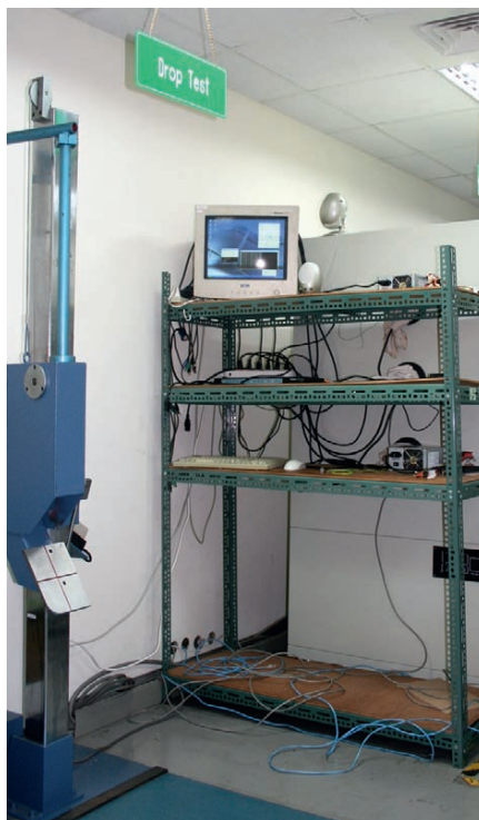
Рис. 3. Стенд для проведения испытаний на устойчивость к ударам
