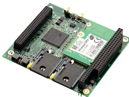
Рис. 2. Коммуникационный модуль FASTWEL серии CNM3xx с поддержкой ГЛОНАСС
