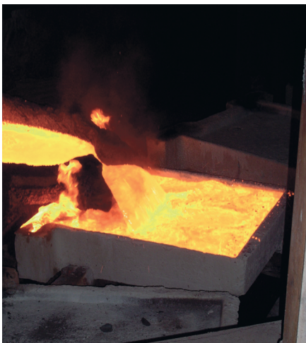
Рис. 4. Так отливается анод (заполнение изложницы медью)
