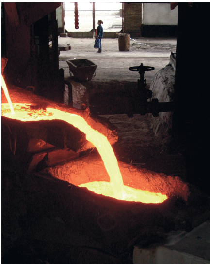
Рис. 3. Заполнение медью дозировочного ковша
