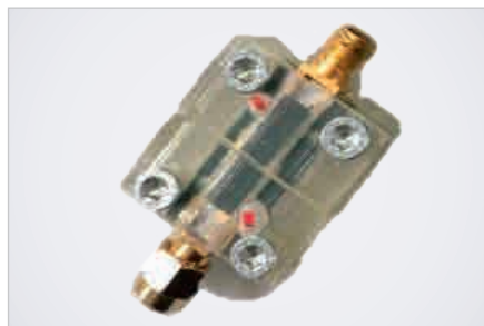
Рис. 7. Блок постоянного тока
