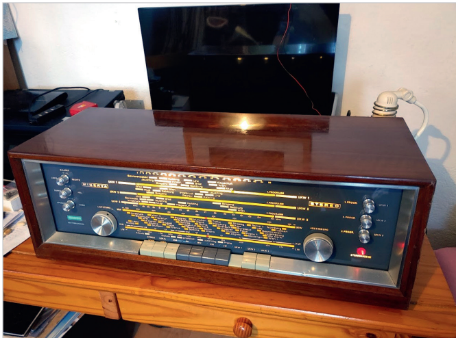
Рис. 5. Внешний вид одной из последних выпущенных на радиолампах моделей радиолы MINERVA STEREO 655
