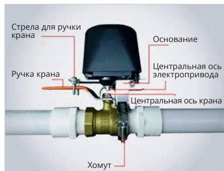
Рис. 5. Электропривод с водопроводным шаровым краном
