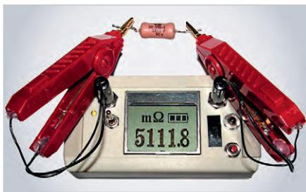
Рис. 8. Измерения на первом диапазоне. Резистор 5,11 Ом, 1% (C2-29B-1)
