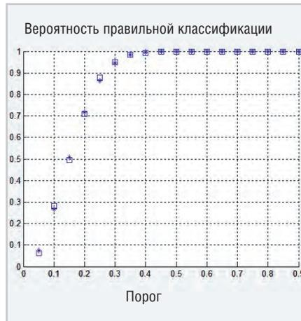
**Рис. 2.** Зависимость вероятности правильной классификации протяжённых объектов от порога  $R_{пор}$  для  $N = 32$  в классификаторе ОМП (звездочки – аналитика, квадраты – моделирование)
