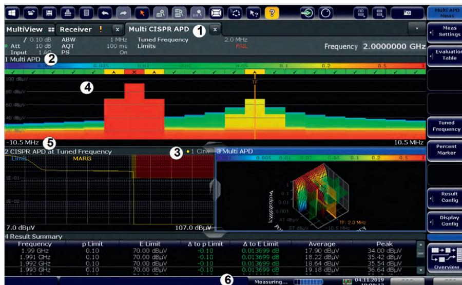
Рис. 9. Окно отображения результатов измерений опции R&S ESW-K58
