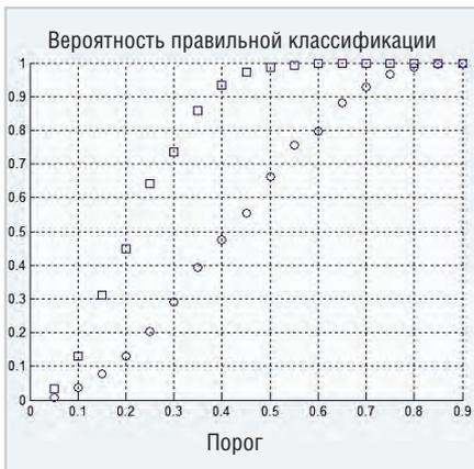
**Рис. 4.** Зависимость вероятности правильной классификации протяжённых объектов от порога  $R_{пор}$  для  $N = 16$  в классификаторе ОМП для коррелированных выборок наблюдений с межпериодным коэффициентом корреляции 0 (квадраты) и 0,9 (кружки)
