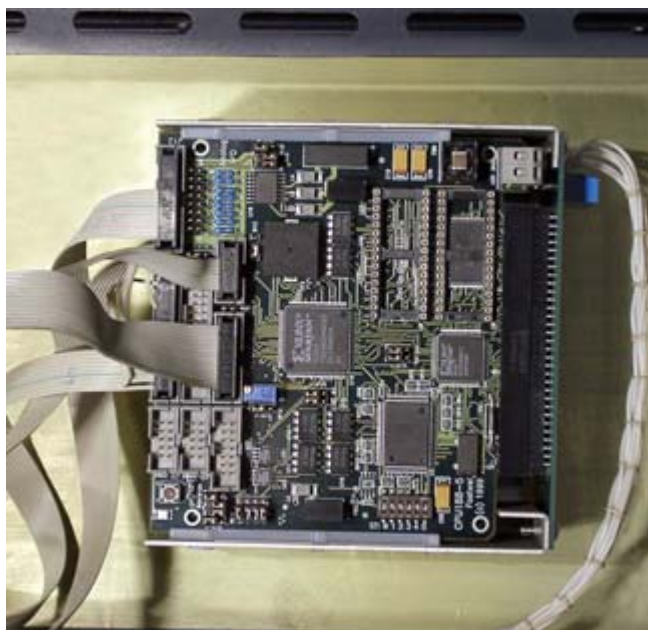
Рис. 5. Каркас 5253 с модулями CPU188-5MX и АО16-V8
