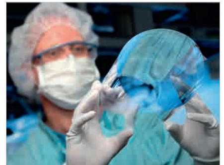
Рис. 5. Ультратонкое гибкое стекло, изготовленное с помощью непрерывной вытяжки
