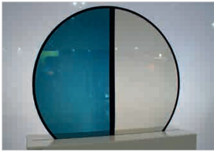
Рис. 2. Экспонат из мягкого изоляционного электрохромного солнцезащитного стекла
