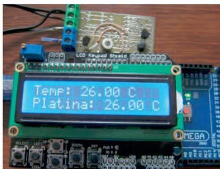
**Рис. 4. Калибровка платинового датчика при комнатной температуре с помощью DS2436, подключённого к Arduino MEGA с LCD-дисплеем**
