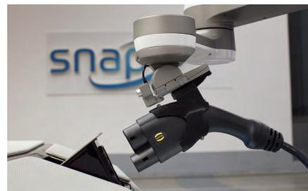
Рис. 5. Разъём HARTING для зарядки электромобиля и робот Kuka
