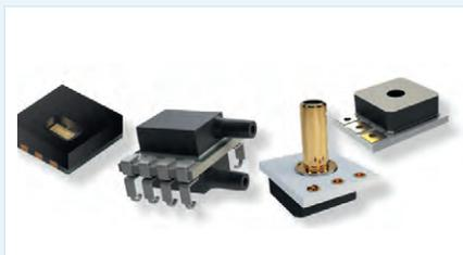
Датчики давления BPS110 и BPS120 поддерживают чрезвычайно точные измерения сверхнизкого давления. Это полностью калиброванные и компенсированные датчики с хорошей долгосрочной стабильностью и повторяемостью.
