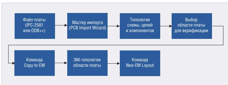
**Рис. 5. Алгоритм ЭМ-верификации печатных плат, импортированных из САПР сторонних разработчиков**
