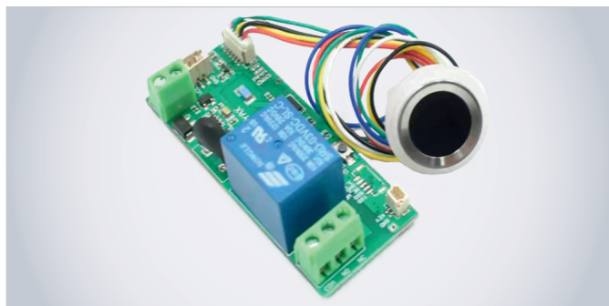
Рис. 11. Вид готового устройства датчика R502 с исполнительным узлом, управляющим электромагнитным замком в триггерном режиме
