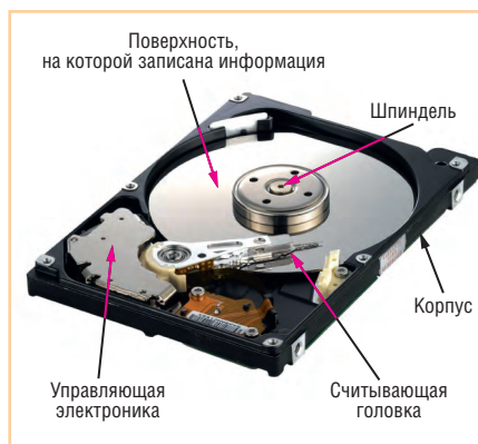
Рис 1. Конструкция НЖМД (со снятой крышкой)
