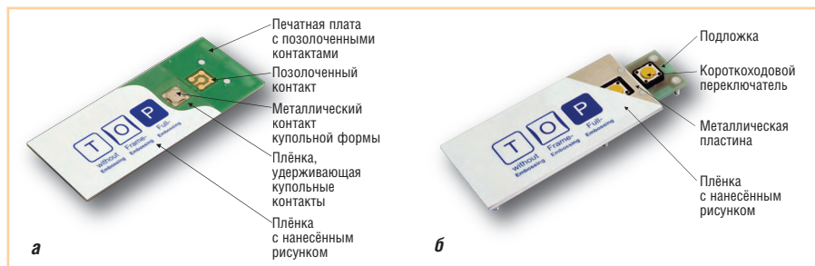
Рис. 1. Конструкция клавиатуры: а) мембранной; б) короткоходовой
