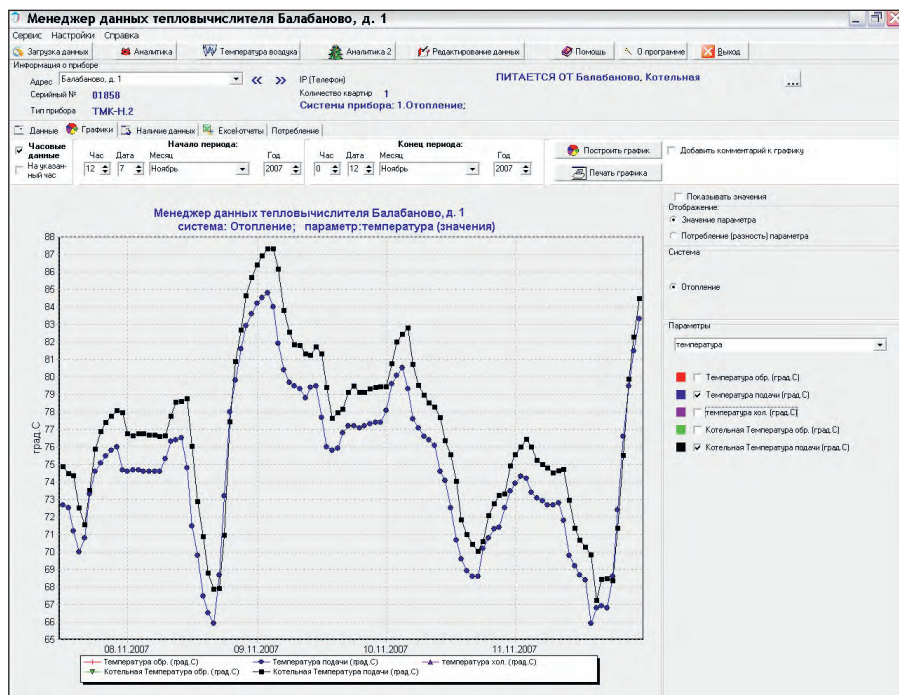
Рис. 4. Одновременное отображение информации о температуре теплоносителя на выходе из котельной и на входе в здание
