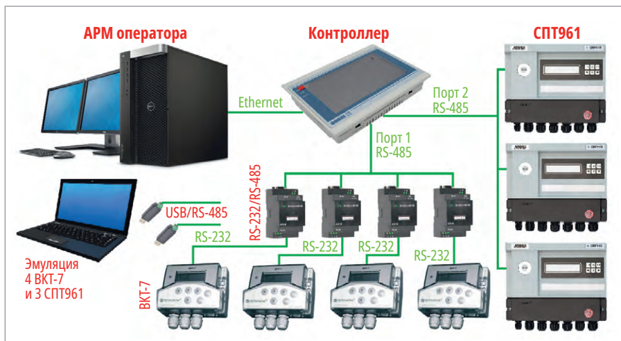
Рис. 1. Структурная схема учёта теплопотребления и ГВС
