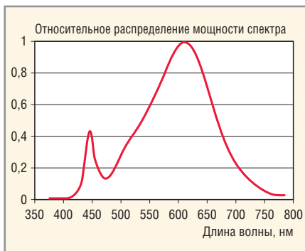
Рис. 8. Спектральная характеристика светодиода LXM3-PW81
