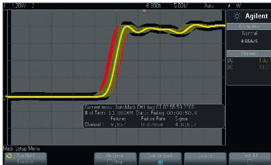
Рис. 2. Тестируемый по маске сигнал с джиттером
