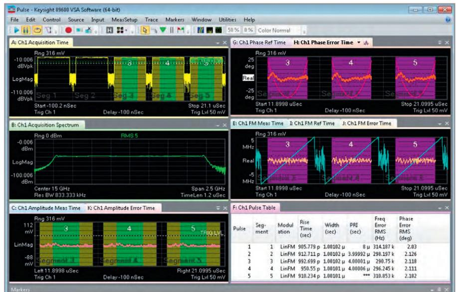
Рис. 4. Расчёты ПО анализа импульсов (расчёты основаны на измерениях, выполненных с использованием сегментированной памяти осциллографа)
