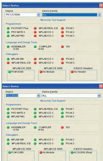
Рис. 12. Перечень программаторов для прошивки микроконтроллера: верхний – PIC12C508A, нижний – PIC12F629
