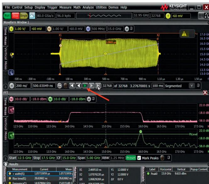
Рис. 3. Сегментированная память осциллографа с полосой пропускания 33 ГГц (содержит 32 000 импульсов в 32 000 сегментах по 1,2 мкс на сегмент)
