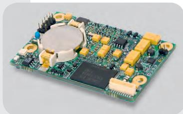
**Компьютерный модуль стандарта FCOM на базе процессора Vortex86DX**
