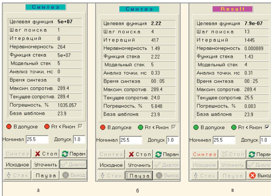
Рис. 7. Шунтовая настройка микрочипа на номинал сопротивления  $R_n = 25,5 \text{ Ом}$ : а – в начальной фазе; б – в промежуточной фазе; в – в конечной фазе
