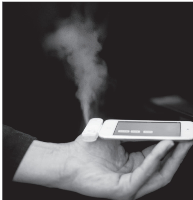
Рис. 2. Приставка к смартфону для распространения запахов в нужное время
