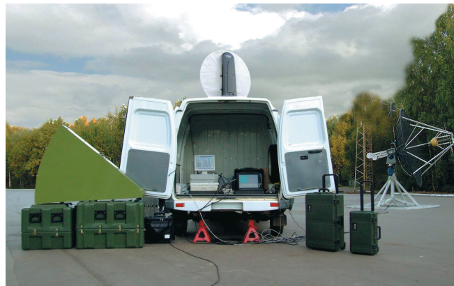
Рис. 4. Развёрнутый в полевых условиях мобильный пункт приёма телеметрической информации (справа — антенна MAS-3, в салоне автомобиля — станция МПРС и компьютер управления антенной, на переднем плане — транспортировочная тара)
