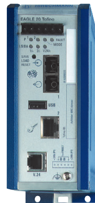
Рис. 21. Аппаратно-программный комплекс EAGLE Tofino для комплексной защиты промышленных сетей от различных киберугроз
