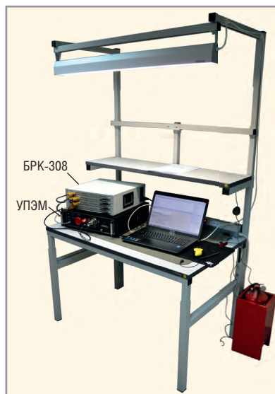
Рис. 4. Пример системы TEST-9110-LXI на 144 канала 3500 DC / 2500 AC
