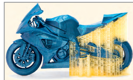
Рис. 2. 3D-модель мотоцикла BMW S1000RR, отпечатанная на принтере Designer PRO 250 с использованием технологии JetSwitch
