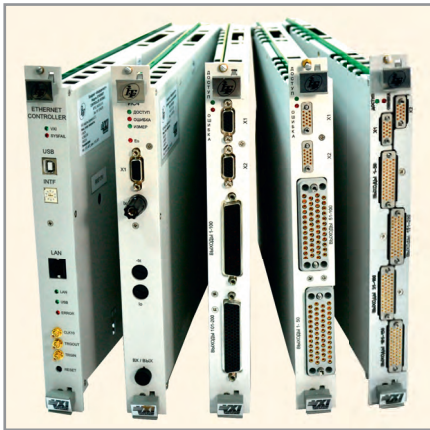
Рис. 3. VXI-модули из состава TEST-9110-VXI
