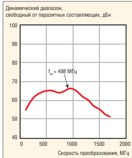
Рис. 7. Зависимость динамического диапазона АЦП ADC10D1000 от скорости преобразования
