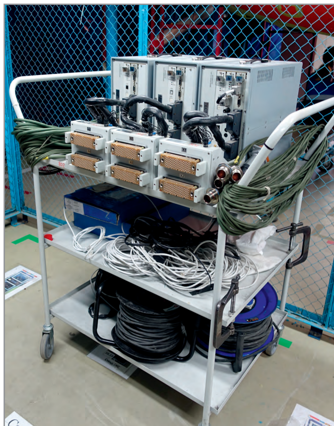
Рис. 12. Переносной вариант распределённой мобильной системы ТЕСТ-9110
