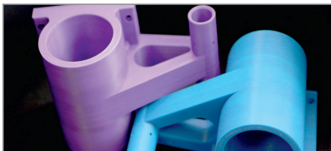
Рис. 3. Мелкосерийное изготовление деталей сложной формы компанией «ЛЕД Микросенсор НТ» на принтере Designer PRO 250
