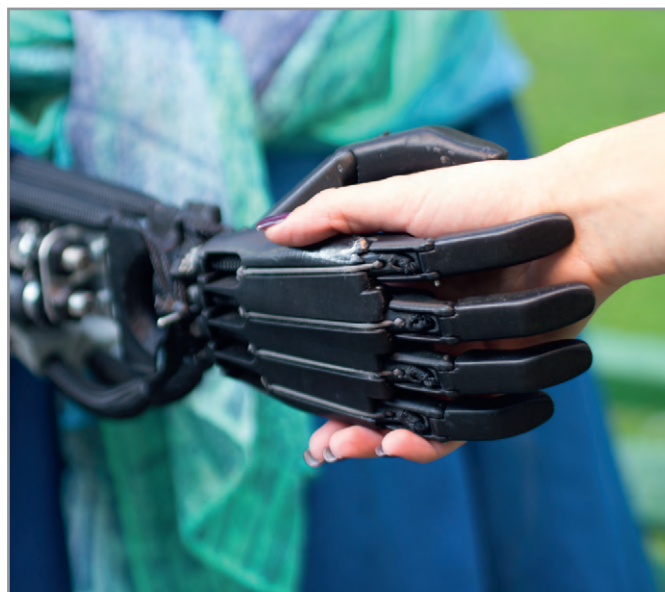
Рис. 6. Тестовая модель руки для робота компании «Нейроботикс», напечатанная на принтере PICASO 3D Designer
