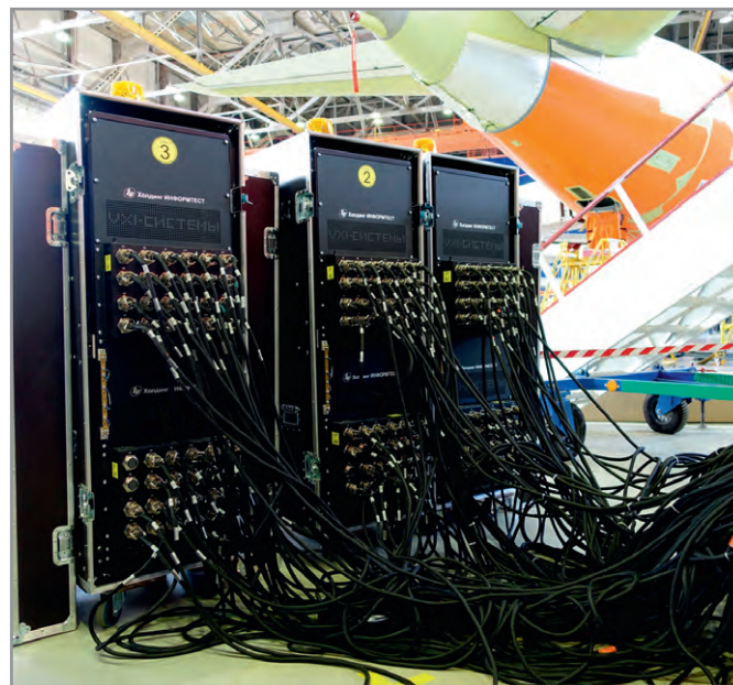
Рис. 2. Вариант распределённой системы ТЕСТ-9110 для проверки самолёта в цехе окончательной сборки
