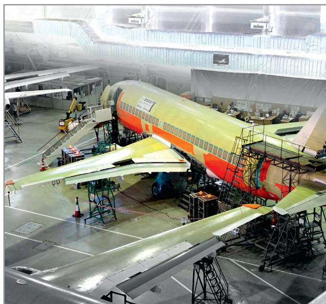
Рис. 1. Комплекс ТЕСТ-9110 в процессе тестирования систем самолёта SSJ-100 в г. Комсомольск-на-Амуре
