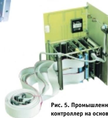
**Рис. 5. Промышленный контроллер на основе MicroPC**
