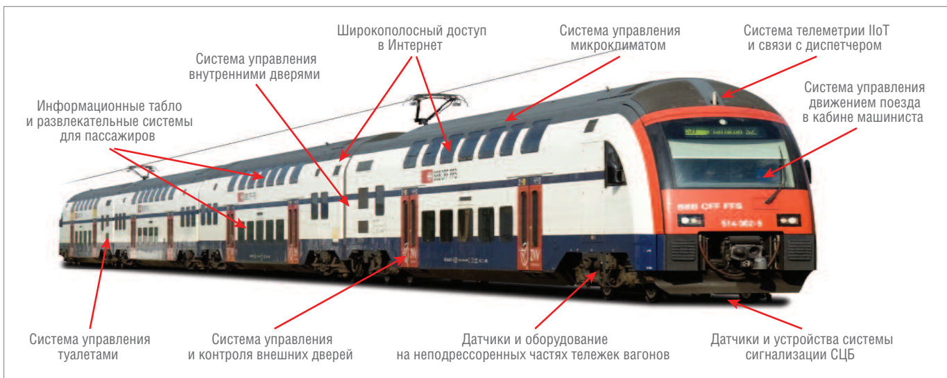
Рис. 1. Электронные системы, которыми оснащён современный поезд
