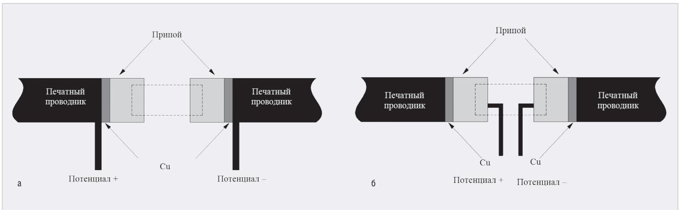
**Рис. 1.** Варианты топологического подключения сверхнизкоомного резистора: а) подключение потенциальных проводников с внешней стороны КП; б) подключение потенциальных проводников с внутренней стороны КП
