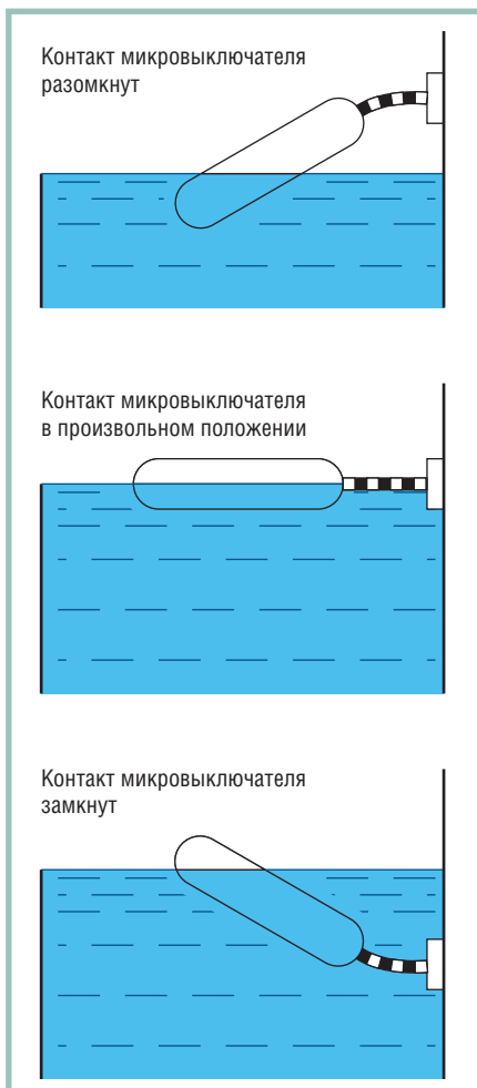
Рис. 1. Принцип действия поплавкового выключателя
