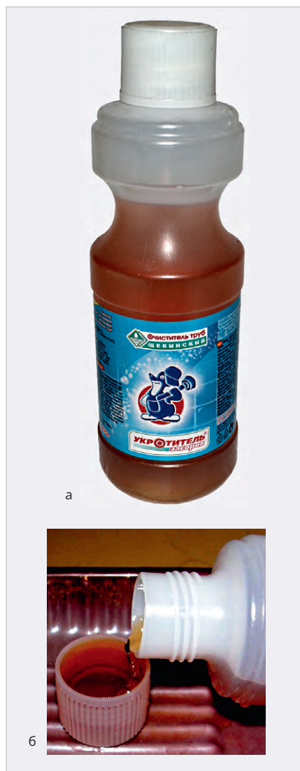
Рис. 21. Приготовление проявителя для заготовки печатной платы: а – очиститель труб «Крот», б – мерка для приготовления раствора проявителя
