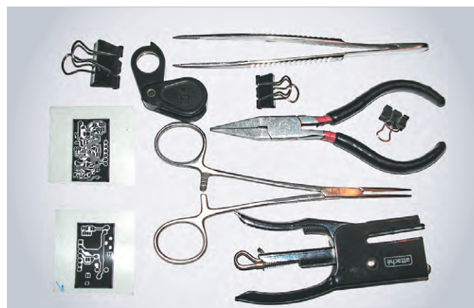
Рис. 9. Инструменты и приспособления для получения двустороннего фотошаблона
