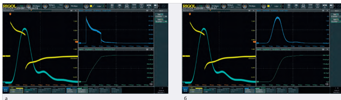
Рис. 17. Результаты измерений, полученные для импульсов длительностью 40 мкс интегрированием квадрата: а) выходного напряжения СФ; б) выходного напряжения СФ
