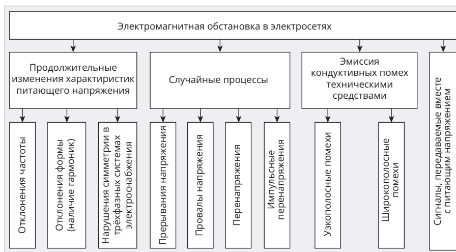
Рис. 1. Составляющие электромагнитной обстановки в сетях электропитания
