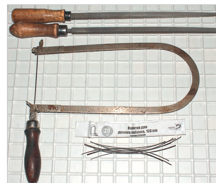
Рис. 14. Инструменты для резки стеклотекстолита и снятия заусенцев с заготовки печатной платы
