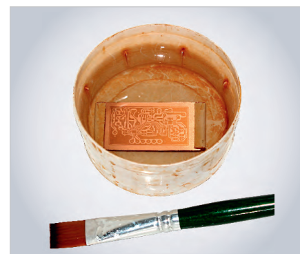
Рис. 22. Проявление заготовки в растворе «Крота»
