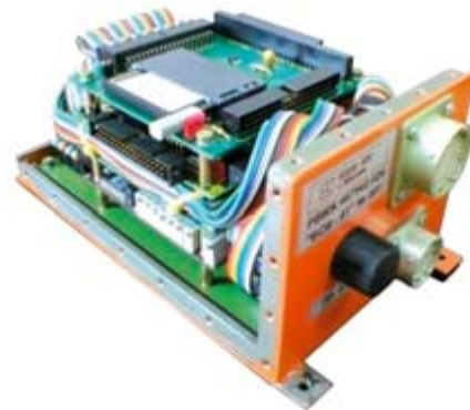
Рис. 4. Внешний вид конструкции устройства со снятой крышкой
