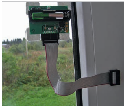
Рис. 9. Способ установки датчика сбора информации на окне
