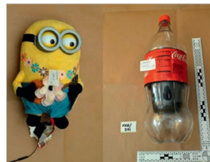
Рис. 14. Отдельные примеры размещения скрытых камер
