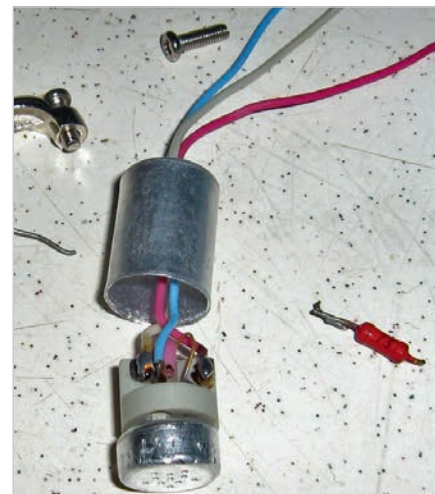
Рис. 1. Электретный микрофон МКЭ-3, являющийся по принципу работы сенсора прообразом современных миниатюрных микрофонов в сотовых телефонах
