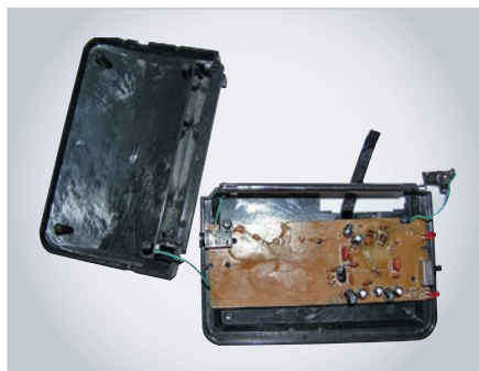
Рис. 3. Вид на плату приёмника FM-диапазона частот
