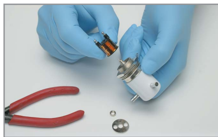
Рис. 3. Процесс замены катушки в реле Gigavac
