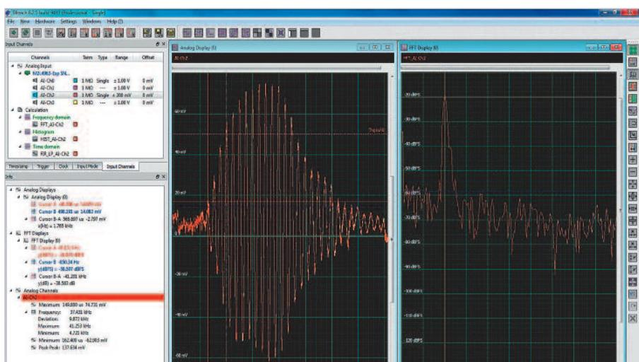
Рис. 37. Пример прикладного ПО, позволяющего дигитайзеру осуществлять непрерывный контроль, просмотр и анализ полученных данных
