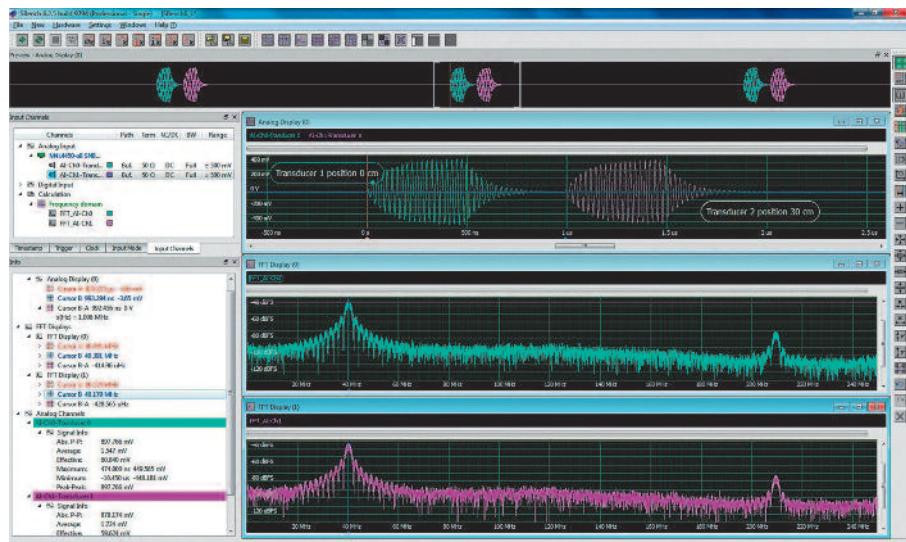
Рис. 41. SBench 6 – мощный интерактивный программный инструмент для сбора и анализа данных
