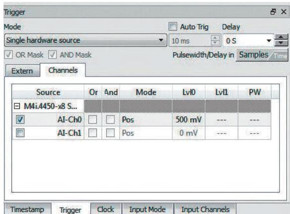
Рис. 43. Окно настроек триггера в SBench 6, обеспечивающее доступ ко всем функциям аппаратного запуска
