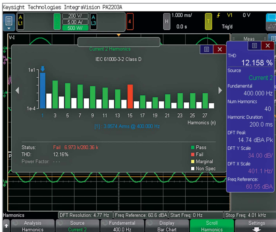
Рис. 4. Пример измерения гармоник, показывающий, что 15-я гармоника слишком велика и не укладывается в требования стандартов к качеству сетей питания
