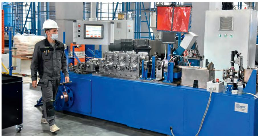
Рис. 4. Станок с ЧПУ и дистанционным управлением – оборудование для производства оболочки магистрального кабеля
