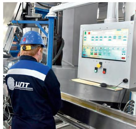
Рис. 7. Модуль управления «прокатным станом» производственного цеха кабельной продукции
