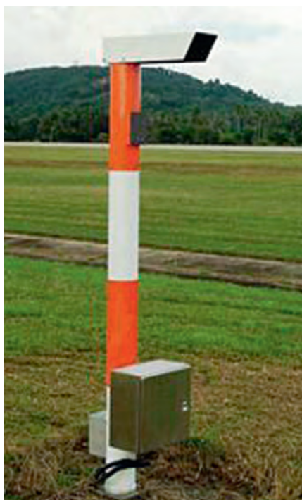
Рис. 5. Оптический диффузомер вблизи аэродрома, обеспечивающий контроль дальности видимости взлётно-посадочной полосы
