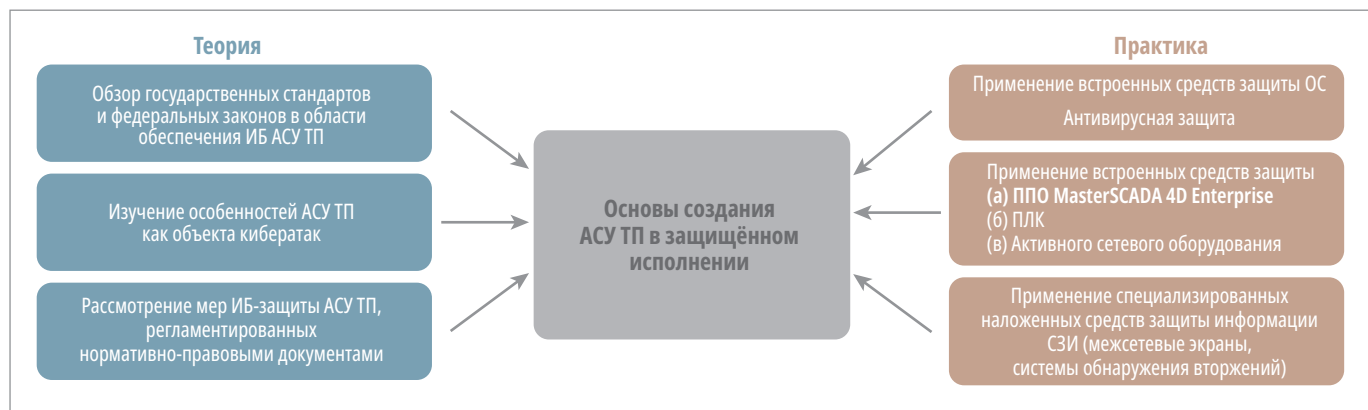
Рис. 1. Концепция учебно-лабораторного стенда «Информационная безопасность в АСУ ТП»
