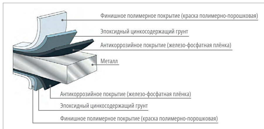
Рис. 6. Антикоррозийная обработка металла в шкафах Remer
