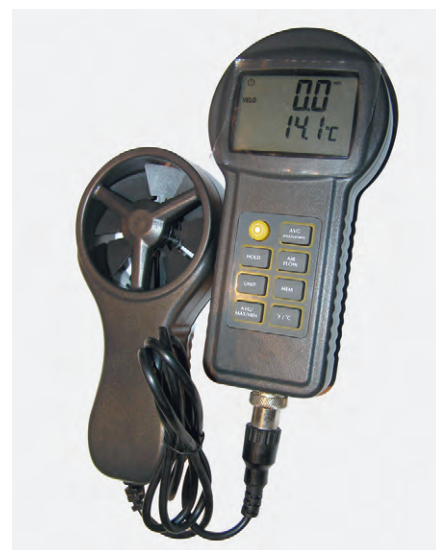
Рис. 2. Переносной анемометр для измерения скорости воздушных потоков (ветра) в широком диапазоне 0,02...30 м/с
