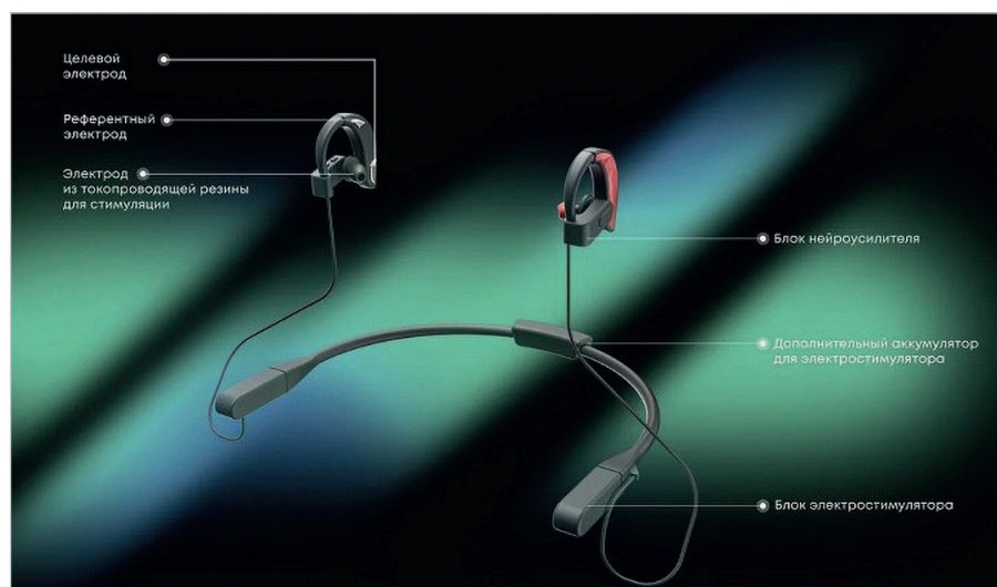
Рис. 11. Вид инновационных наушников с обозначением основных функциональных модулей
