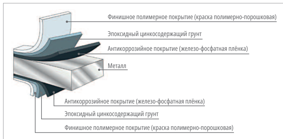
Рис. 6. Антикоррозийная обработка металла в шкафах Remer
