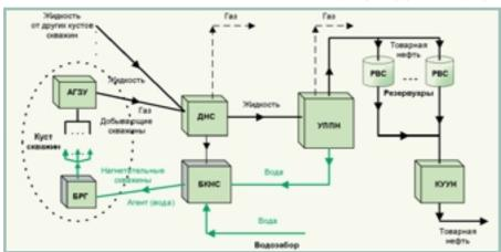
Условные обозначения: АГЗУ — автоматическое газозамерное устройство; БРГ — блок распределительных гребёнок; ДНС — дожимная насосная станция; БКНС — блочная компрессорная насосная станция; УППН — установка подготовки и перекачки нефти; КУУН — коммерческий узел учета нефти; РВС — резервуар вертикальный стальной.
