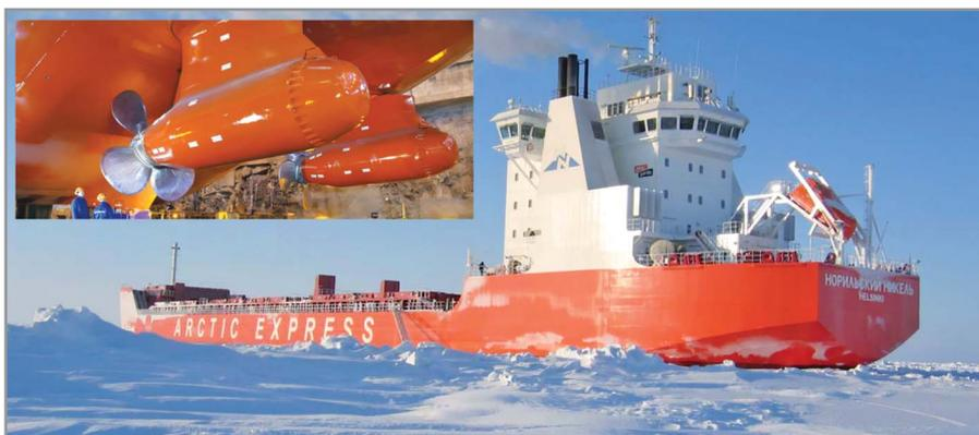
Рис. 5. Дизель-электрический ледокол «Норильский Никель» с пропульсивной системой Azipod
