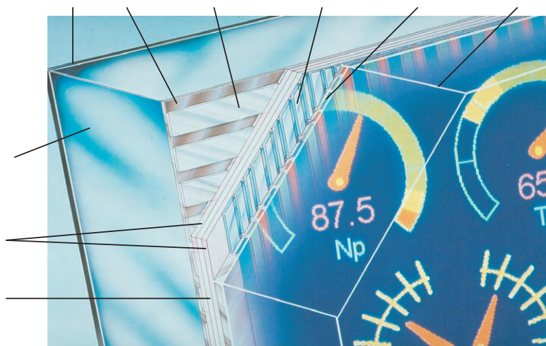
Рис. 1. Структура тонкопленочного ЭЛ-дисплея
