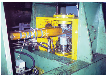
Рис. 3. Стенд для испытаний на сопротивление усталости втулки несущего винта
