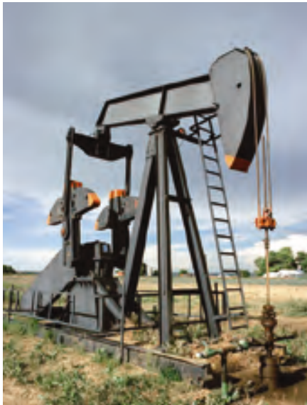
Рис. 1. Традиционная насосная установка
