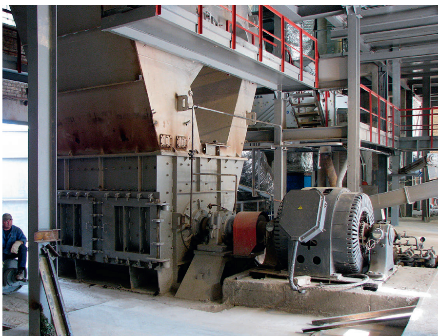
Рис. 1. Тангенциальная молотковая мельница со встроенным лабиринтным сепаратором
