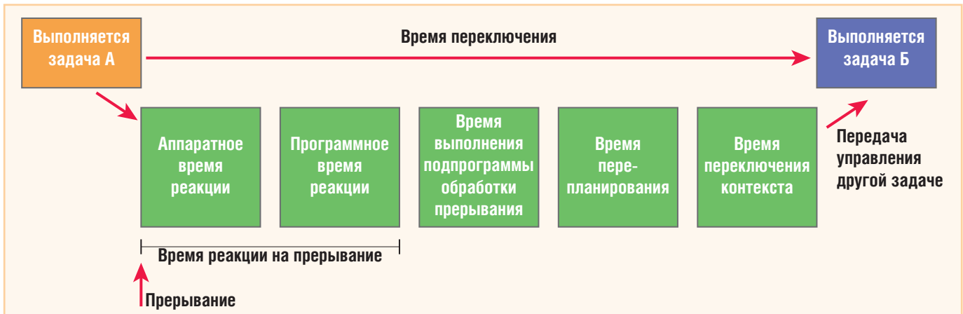
Рис. 1. Реакция ОС на прерывание (с перепланированием)
