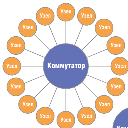
Рис. 9. Сетевая топология типа «звезда»
