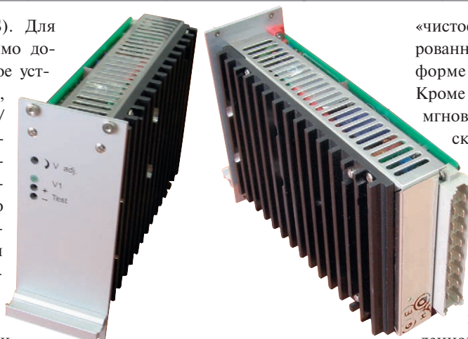
Рис. 2. Блок питания Schaefer серии C1300 (CP1300): вид сзади и вид спереди
