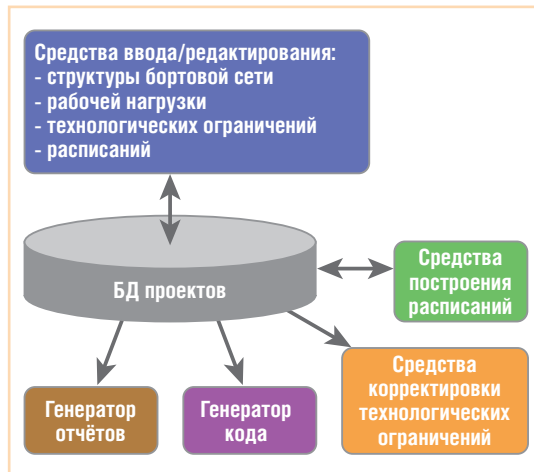
Рис. 4. Структура инструментальной системы «САПР циклограмм»
