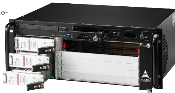
Рис. 13. Внешний вид конструкции платформы cPCIS-6400U
