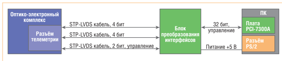
Рис. 3. Структурная схема телеметрической системы
