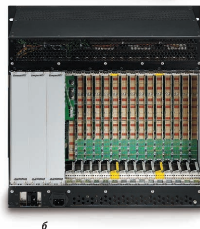
Рис. 11. Внешний вид конструкции платформы cPCIS-3300BLS спереди (а) и сзади (б)
