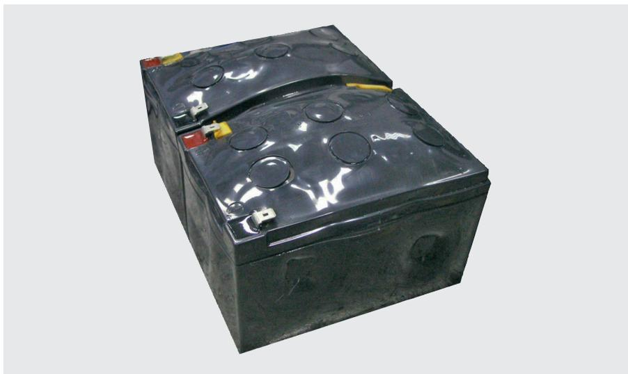
Рис. 2. Изменение геометрии корпуса в результате термического разгона
