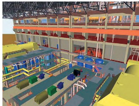
Трехмерные модели, созданные по P&ID диаграммам
