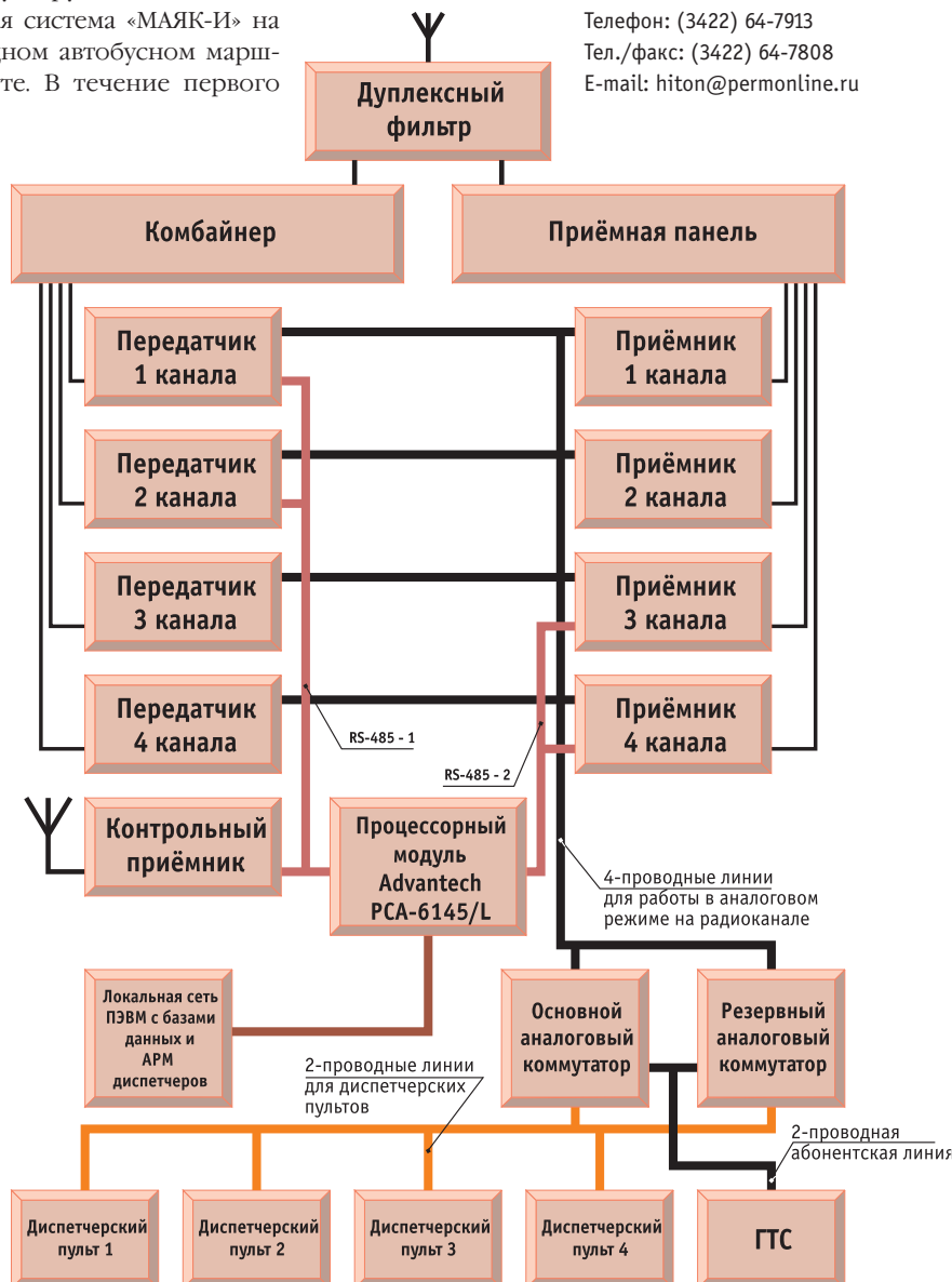
Рис. 9. Структура четырехканального базового центра системы «МАЯК-И»
