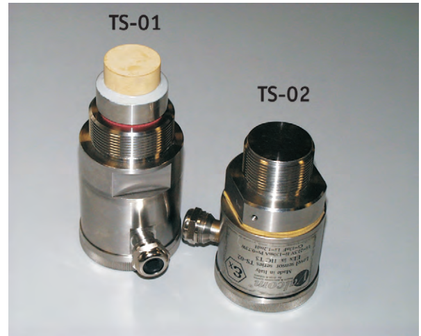
Рис. 1. Сонары TS-01 и TS-02 фирмы Valcom
