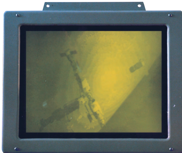
Рис. 2. Изображение на экране дисплея в исходной палитре после исключения черного цвета
