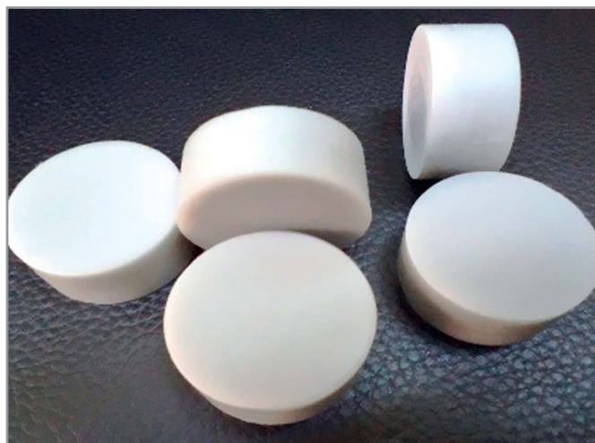
Рис. 2. Прессованные диски из AlN-гранулята
