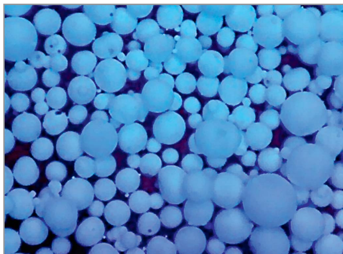
Рис. 1. Гранулят из нитрида алюминия, полученный на грануляторе XLB-3
