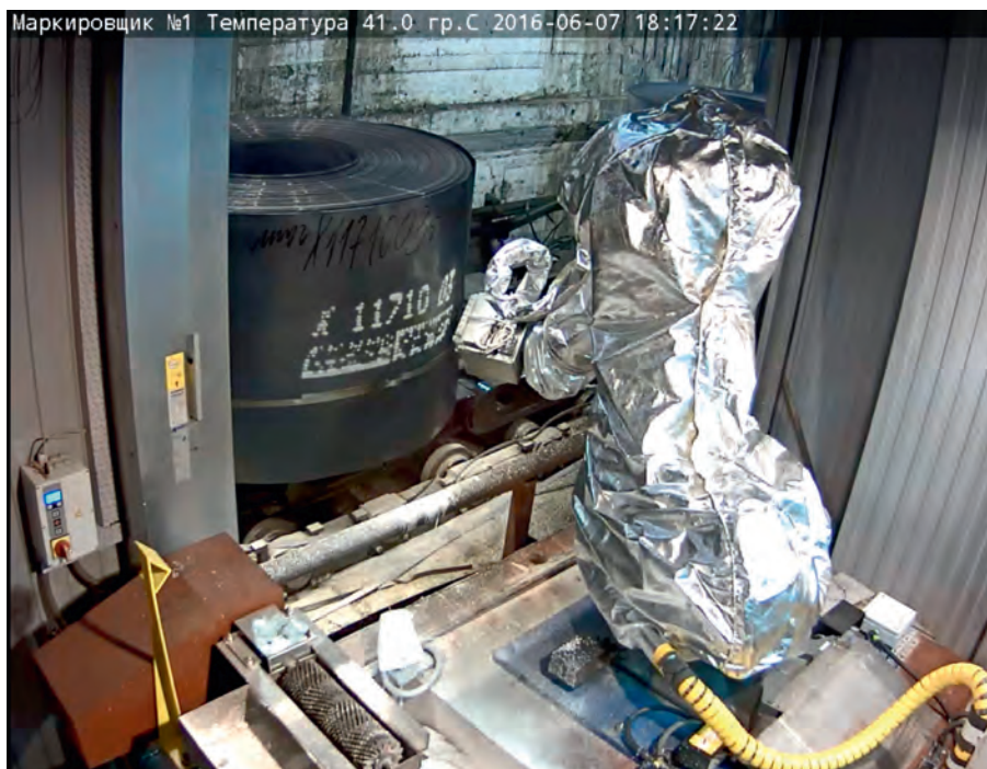
Рис. 2. Маркировка рулона БАР-кодом, вид из камеры распознавания
