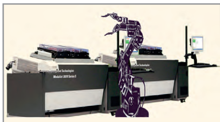
Рис. 1. Типовая конструкция роботизированного манипулятора для промышленного внутрисхемного тестирования
