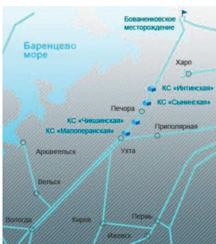
Рис. 3. Газопровод «Северный поток». Объекты установки ГПА 32 МВт «Ладога»
