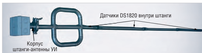
Рис. 7. Термоштанга в собранном виде
