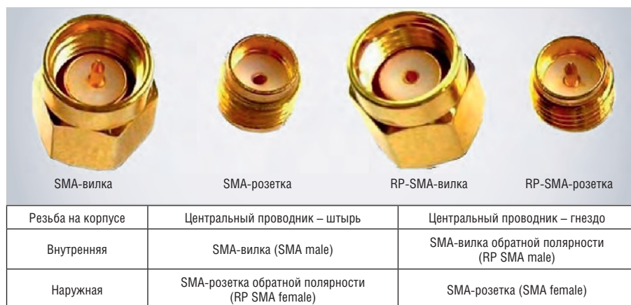
Рис. 1. Соединители SMA прямой и обратной полярности
