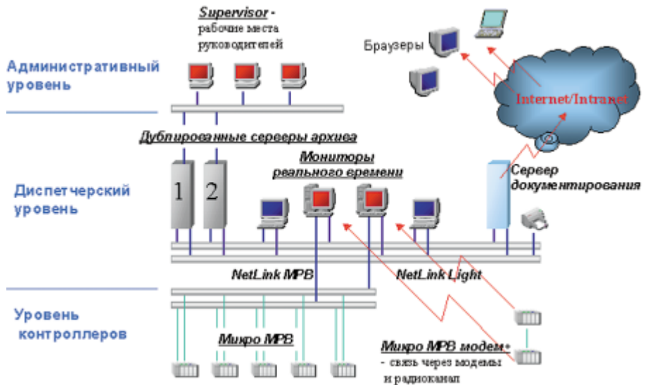
Рис. 5. Распределенная многоуровневая АСУ ТП на базе TRACE MODE
