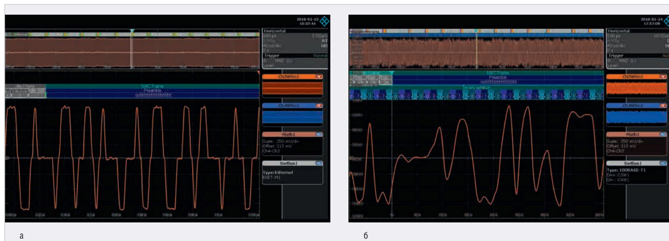
Рис. 1. Дифференциальный сигнал 100BASE-Tx (а) и сигнал стандарта 100BASE-T1 (б) в автомобильных сетях
