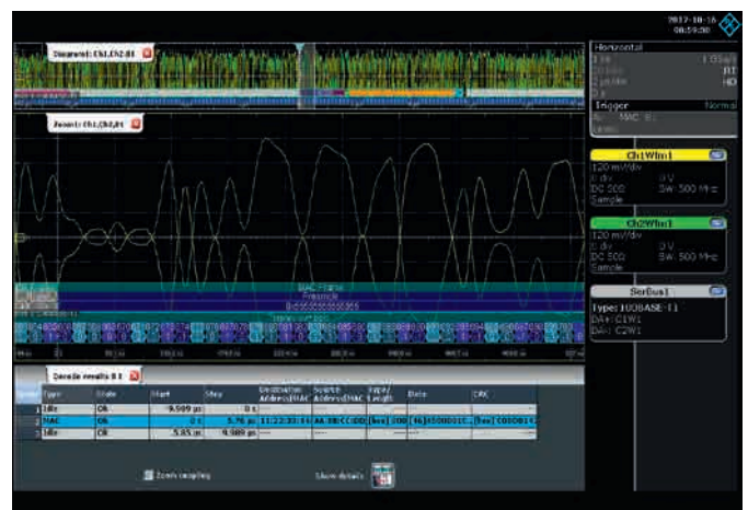
Рис. 4. Декодирование уровней сигнала 100BASE-T1 электрической шины
