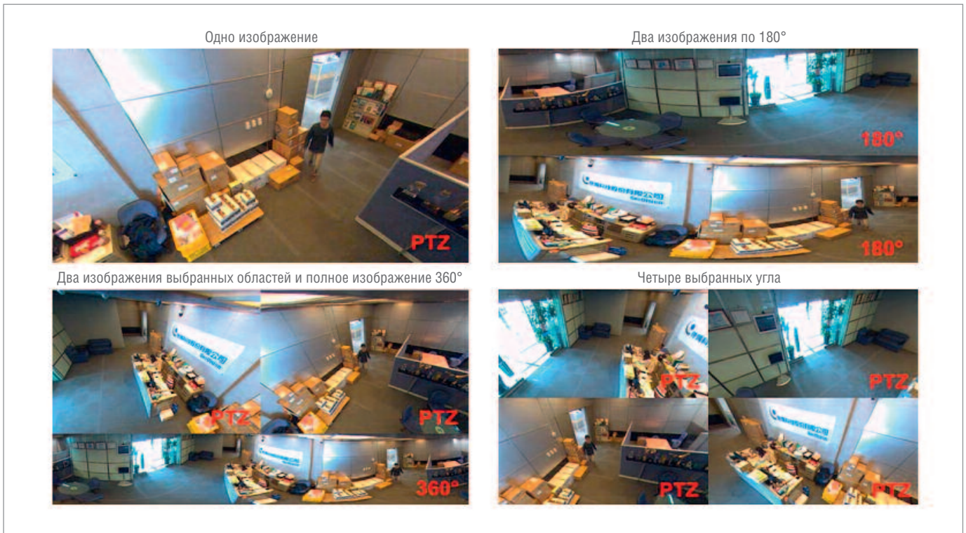
Рис. 3. Развёртка изображения камеры с объективом «рыбий глаз»
